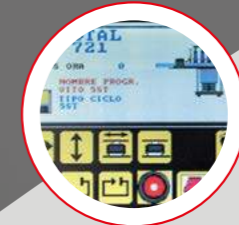
PULIZIA TAMPONI (OPZIONALE) La pulizia tamponi è automatica e programmabile direttamente dalla tastiera
