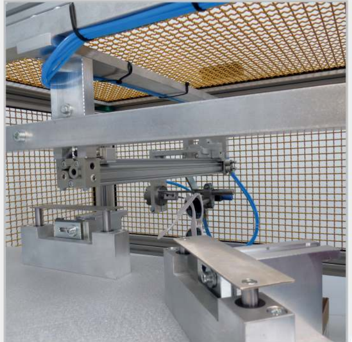
SISTEMA DI SCARICO AUTOMATICO E CHIUSURA OCCHIALE AUTOMATIC SYSTEM TO CLOSE THE GLASSES' ARMS DURING THE DISCHARGING OPERATION
